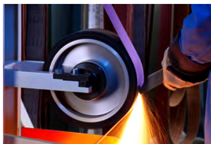
Entgratungsarbeiten | Angüsse entfernen
